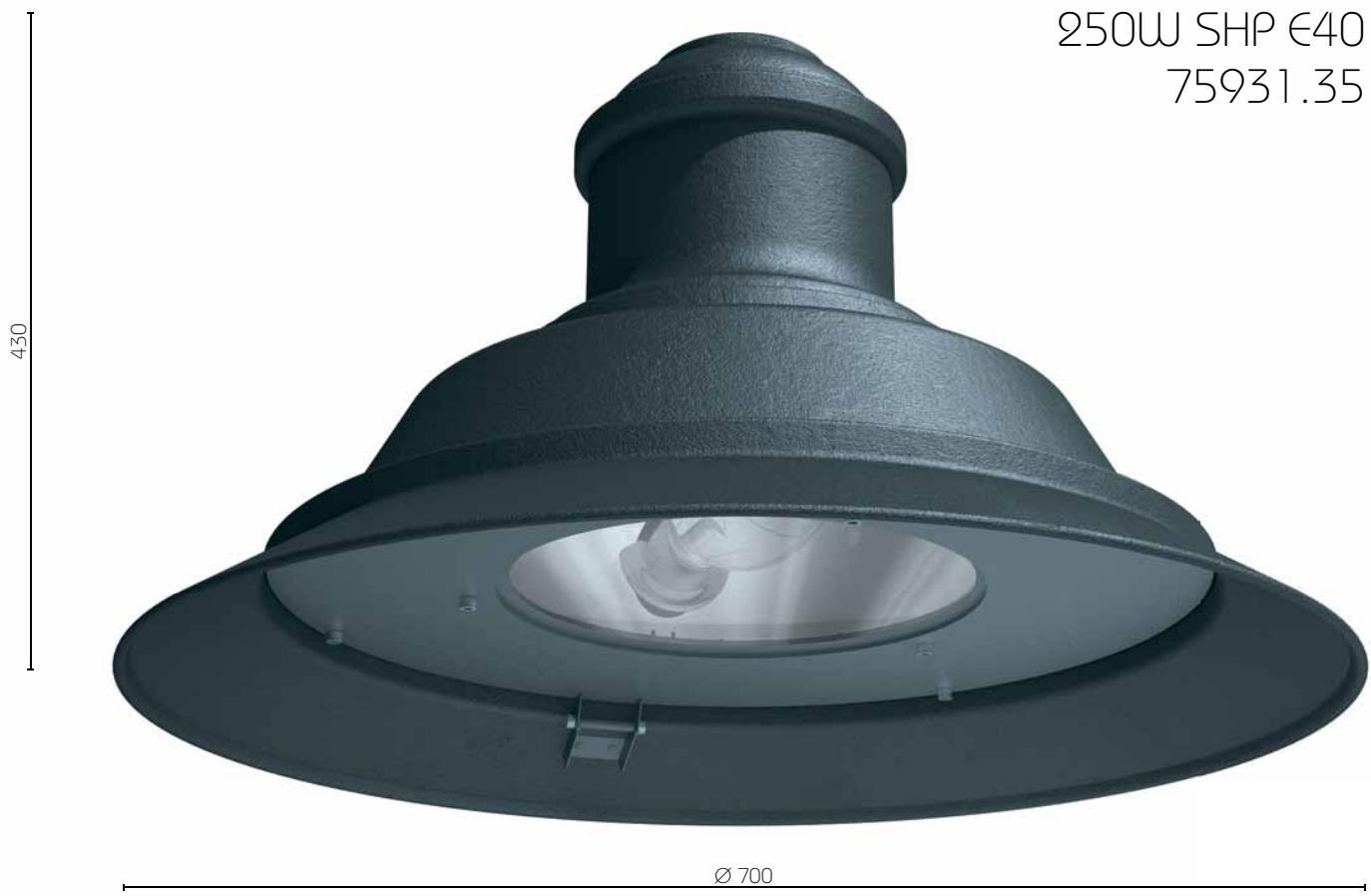
Aluminium-Laterne für eine optimale Wärmeableitung, mit Schutzbehandlung und Pulverbeschichtung, einschließlich hochleistungsfähiger Optik und Verkabelung für Natriumdampf-Hochdrucklampen.
