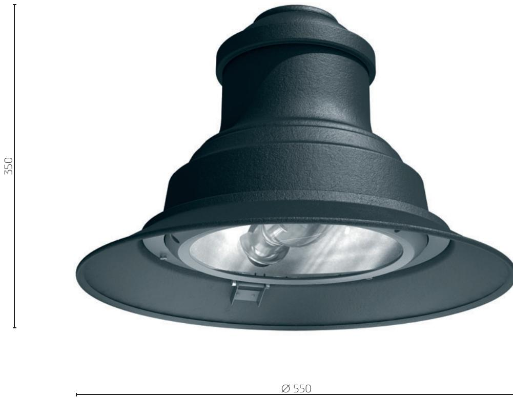
Lanterna in alluminio per una ottimale dissipazione del calore, con trattamento di protezione e verniciatura a polvere con all'interno un'ottica in alluminio ad alto rendimento e cablaggio per lampada sodio alta pressione.
